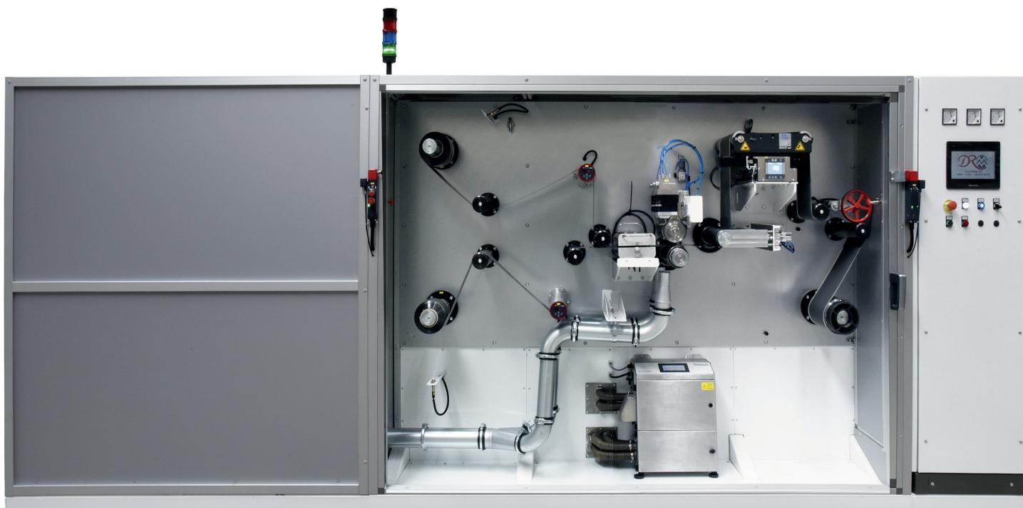
LA MACCHINA TAGLIERINA E RIBOBINATRICE È PROGETTATA PER TAGLIARE STRISCE CON UNITÀ DI TAGLIO E CON RIMOZIONE DEI BORDI. UNA CABINA DI SICUREZZA COLLEGATA A UN DISPOSITIVO DI ASPIRAZIONE ESTERNO LIMITA I RISCHI DI DISSEMINAZIONE DI PICCOLE PARTICELLE E GARANTISCE UNA PROTEZIONE MECCANICA DELL'OPERATORE.
